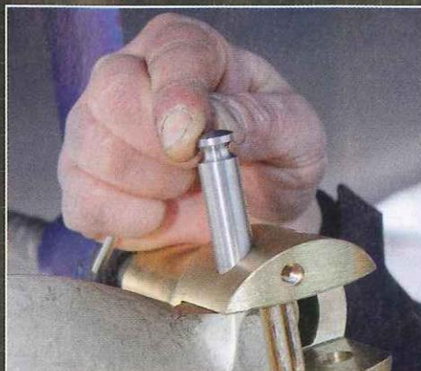
▲ La tête d'axe de chaque pale est échancrée de manière à être bloquée par la vis de maintien.
