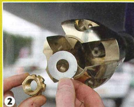
2 ▲ Le moyeu se fixe sur le cône avec une simple rondelle et un écrou (non fourni, voir intro).
