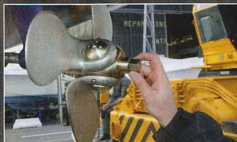
▲ L'Autoprop est fournie entièrement montée; il n'y a plus qu'à la fixer à l'aide de l'écrou fourni.
