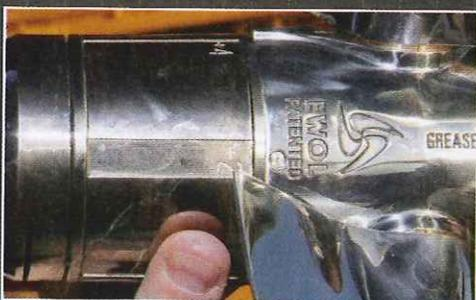
▲ On règle le pas à l'aide d'une bague, et on le verrouille en serrant une vis à travers l'anode.
