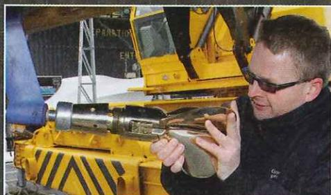
▲ L'hélice s'enchâsse dans le moyeu-embase qu'on a préalablement fixé au cône de l'arbre.
