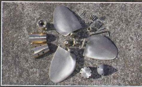
▲ Le montage de la Maxprop est un vrai Meccano, et il faut la démonter en partie pour régler le pas.
