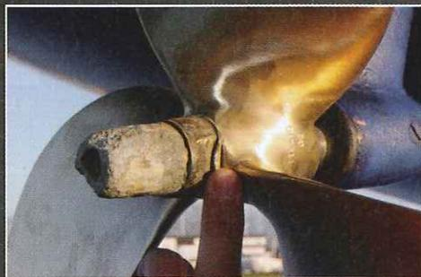
▲ On recourbe la rondelle sur l'écrou pour le bloquer. Notez l'état de l'anode, à changer sous peu.
