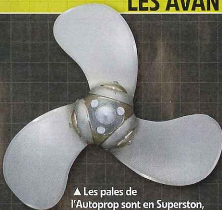
▲ Les pales de l'Autoprop sont en Superston, un alliage bronze-manganèse également utilisé pour les hélices de sous-marins.
